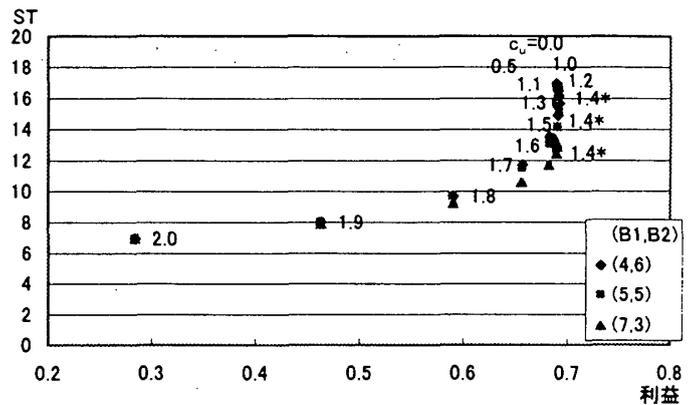
図3. バッファ配分 $(B_1, B_2)$ と客の受け入れ利益基準 $c_u$ を変化させたときの総利益と平均滞在時間 $(\bar{\lambda} = 0.7, \mu_1 = 0.8, \mu_2 = 0.2)$
