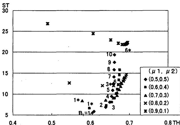
図2. サービス率分配 $(\mu_1, \mu_2)$ とステーション1のバッファサイズ $B_1$ を変化させたときのスループットと平均滞在時間 $(\bar{\lambda} = 0.7, B_2 = 3)$
