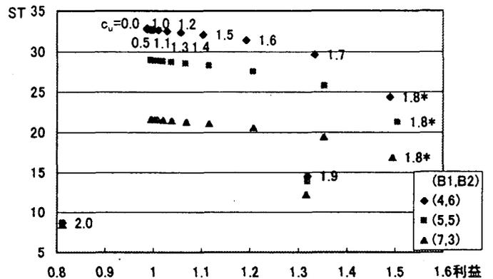
図4. バッファ配分 $(B_1, B_2)$ と客の受け入れ利益基準 $c_u$ を変化させたときの総利益と平均滞在時間 $(\bar{\lambda} = 2.0, \mu_1 = 0.8, \mu_2 = 0.2)$
