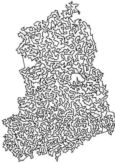
図 9: 巡回セールスマン問題ギャラリー 7: 4461 都市問題の近似解: この解は Nearest Neighbor 法 + 2-opt 法によって求められた。
