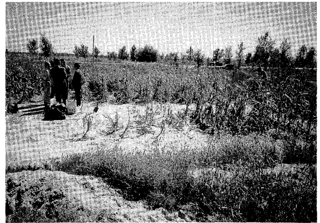
写真2 瀋陽市郊外で筆者らが実施している脱硫石膏を用いたアルカリ土壌改良実験
