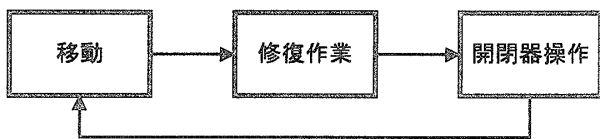
図1 復旧作業のフロー
